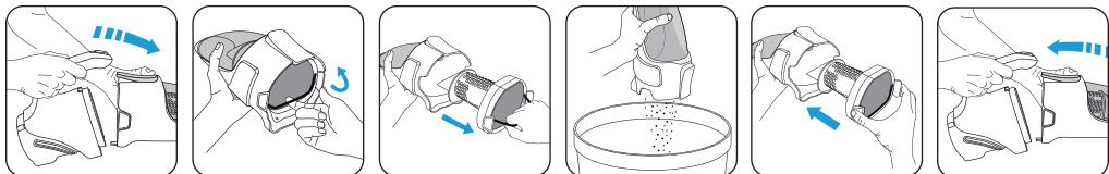
**ПРИМІТКА :** для того щоб очистити пилозбирник та/або сепаратор, промийте його (ix) теплою водою та дайте йому (iім) висохнути або витріть його (ix) м'якою тканиною. Ніколи не мийте ні пилозбирник, ні сепаратор в посудомийній машині.
